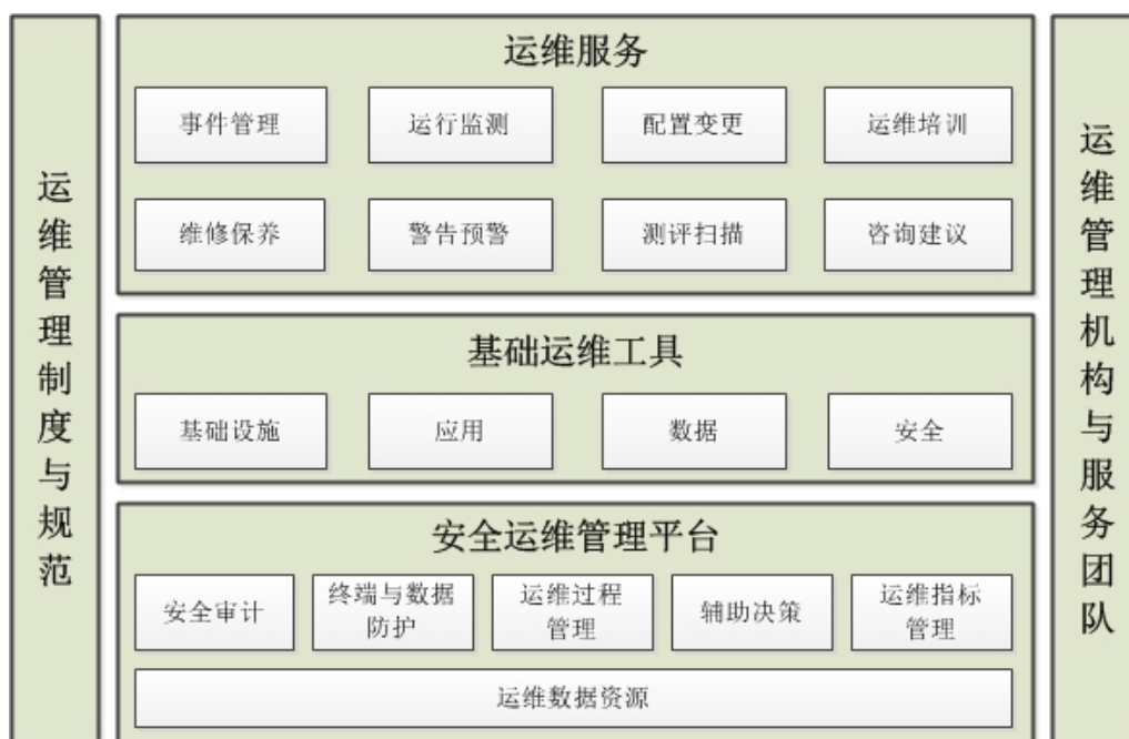
图 5 市级系统运行维护框架图
